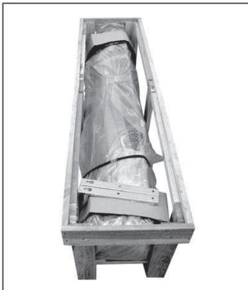
Для перевозки воздушной завесы используется деревянный короб, защищающий устройство от повреждения. Во время манипуляции с упаковкой избегайте механических повреждений, например, падений воздушной завесы. Устройство должно храниться в сухом помещении с температурой окружающей среды от 0°C до +40°C.
